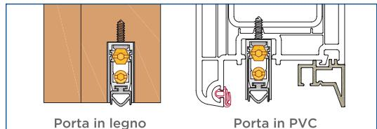
• **CARATTERISTICHE** Meccanismo (BREVETTATO) con la discesa parallela del profilo mobile con guarnizione, caratterizzato dalla DOPPIA REGOLAZIONE (Vite E: discesa - vite R: Inclinazione) per una forte pressione omogenea su tutta la lunghezza.
